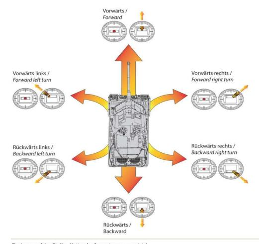
Drehung auf der Stelle - Ketten laufen entgegengesetzt / rotation - chains run opposite direction
