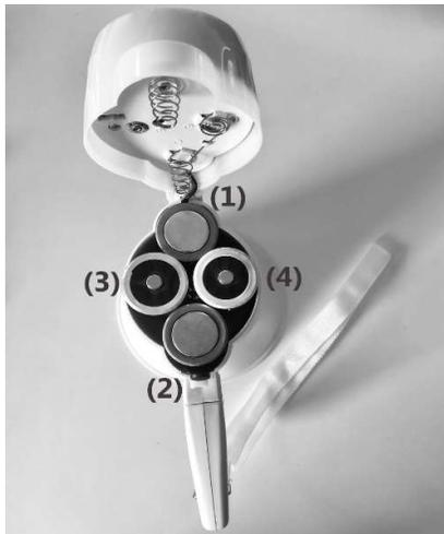
Funktioniert das Megaphone jetzt nicht, oder lässt sich der Deckel nicht schließen (leichter Druck kann beim ersten mal nötig sein, damit genug Kontakt hergestellt wird). So sind entweder die Batterien nicht in der richtigen Reihenfolge, oder mit falscher „+“ und „-“ Polarität eingesetzt worden.
